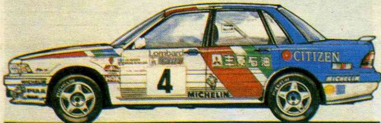
«МИЦУБИСИ-ГАЛАНТ-ВР-4». Четырехдверный седан; четыре ведущих и управляемых колеса; рабочий объем двигателя — 1997 см 3 , мощность — 290 л. с./213 кВт при 6250 об/мин [у серийной модели — 220 л. с./162 кВт при 6000 об/мин], турбонаддув; снаряженная масса — 1228 кг.
