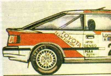
«ТОЙОТА-СЕЛИКА-ГТ4». Трехдверный хэтчбек; при 1998 см 3 , мощность — 295 л. с./217 кВт при 6000 об/мин, турбонаддув; снаряженная масса — 1248 кг.
