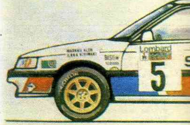
«СУБАРУ-ЛЕГАСИ-4ВД-ТУРЕО». Четырехдверный двигатель — 1991 см 3 , мощность — 295 л. с./217 кВт при 6400 об/мин, турбонаддув; снаряженная масса — 1248 кг.
