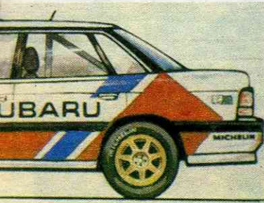
привод на все колеса; рабочий объем двигателя — 1995 см 3 , мощность — 201 л. с./148 кВт при 7000 об/мин [у серийной модели — 201 л. с./148 кВт — 1168 кг.
