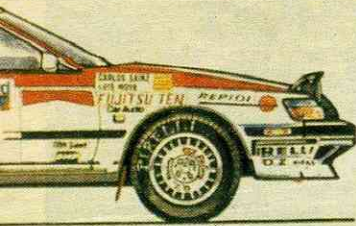
привод на все колеса; рабочий объем двигателя — 1995 см 3 , мощность — 201 л. с./148 кВт при 7000 об/мин [у серийной модели — 201 л. с./148 кВт — 1168 кг.
