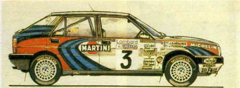
«ЛЯНЧА-ДЕЛЬТА-ХФ-ИНТЕГРАЛЕ-16В». Пятидверный хэтчбек; привод на все колеса; рабочий объем двигателя — 1995 см 3 , мощность — 295 л. с./217 кВт при 7000 об/мин [у серийной модели — 220 л. с./162 кВт при 5500 об/мин], турбонаддув; снаряженная масса — 1099 кг.
