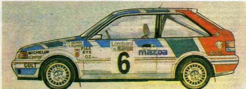
«МАЦУДА-323-ГТИКС». Трехдверный хэтчбек; привод на все колеса; рабочий объем двигателя — 1839 см 3 , мощность — 270 л. с./198 кВт при 6000 об/мин [у серийной модели — 180 л. с./132 кВт при 6000 об/мин], турбонаддув; снаряженная масса — 1149 кг.
