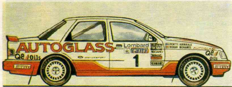
«ФОРД-СЬЕРРА-КОСВОРТ-4X4». Четырехдверный седан; привод на все колеса; рабочий объем двигателя — 1993 см 3 , мощность — 295 л. с./217 кВт при 7000 об/мин [у серийной модели — 220 л. с./162 кВт при 6250 об/мин], турбонаддув; снаряженная масса — 1248 кг.
